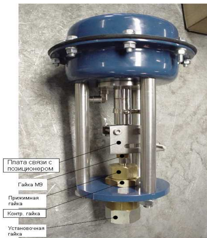
Рис. 2. Пневмопривод с платой связи позиционера.
